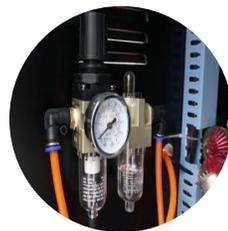
Ajuste de presión Neumática
